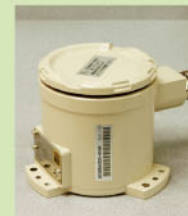
供給エリア内約4,000箇所 に設置されたSIセンサー (地震計)
